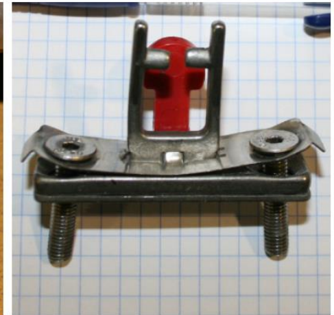
Imagen 2. Dispositivo enclavamiento defectuoso, tuerca y detalle del teton del dispositivo de enclavamiento.
